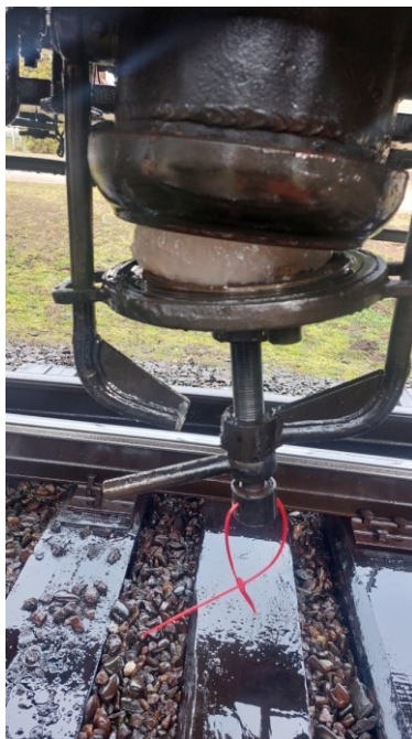
Фото 1 – Ледяная пробка в нижнем сливном приборе вагона № 73125379.
